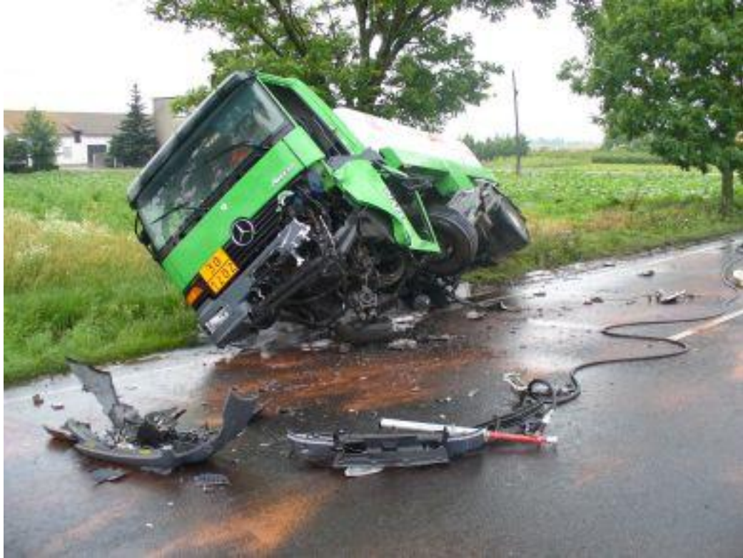
Zdjęcie 17 Samochód ciężarowy cysterna z olejem opalowym uszkodzony po zderzeniu z samochodem Volvo. W wyniku uszkodzeń cysterna wpadła do przydrożnego rowu. Na szczęści nie doszło do wycieku z cysterny, jednak dla bezpieczeństwa podwozie zostało pokryte warstwą piany gaśniczej. Fot. archiwum KP PSP w Inowrocławiu.
