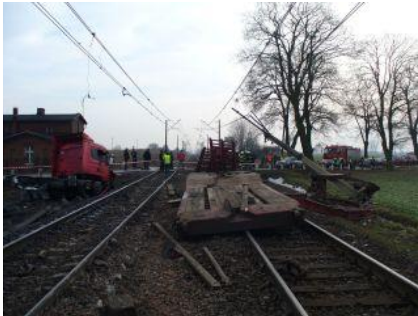
Zdjęcie 3 Rozbity po zderzeniu z pociągiem Intercity zestaw ciągnik siodłowy i naczepa niskopodwoziowa oraz uszkodzona trakcja. Fot. archiwum KP PSP w Inowrocławiu.
